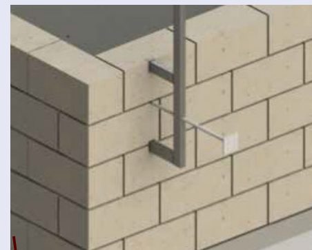
Figura 3 - Instalação da Barra de ancoragem
