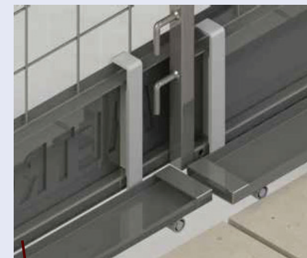
Figura 8 - Colocação das calhas
