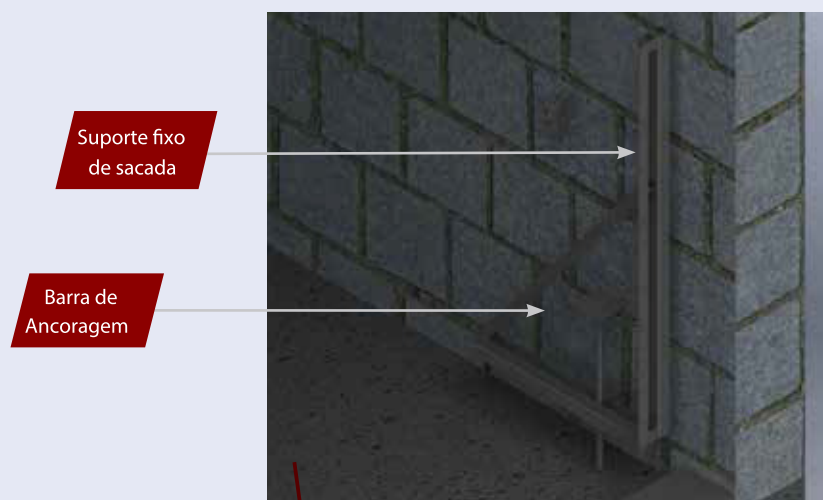
Figura 17 - Fixação do suporte
