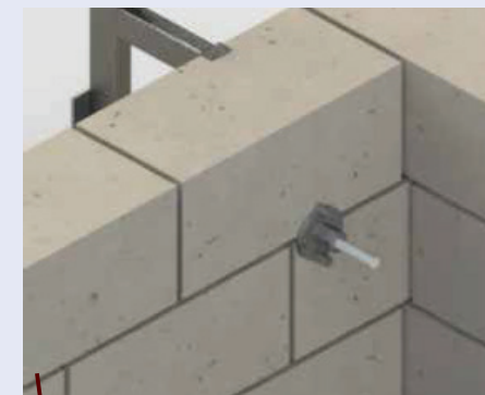
Figura 4 - Travamento da barra
